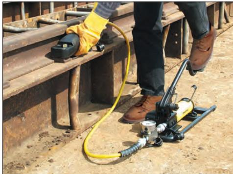
◀ Facilidade de remoção de porcas enferrujadas durante a construção de estrada de ferro é somente um dos muitos exemplos de aplicação para o Cortador de Porcas Enerpac.
